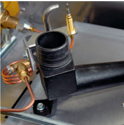
Tubo Venturi a 90° que impide que la eventual suciedad obture la boquilla.
